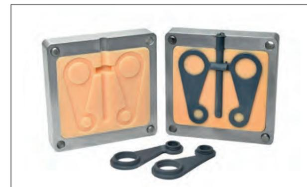
A la izquierda, molde impreso en 3D (DLP Resina) dentro de un soporte metálico.
