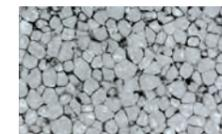
**DIGICEL 4.0:** Herramienta de control de la estructura celular de espumas poliméricas integrado en la línea de producción y en un entorno digitalizado
