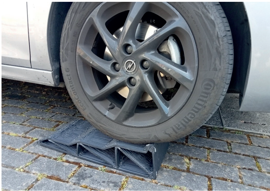
Ilustración 2: Calzo para automóviles impreso mediante proceso BAAM.
