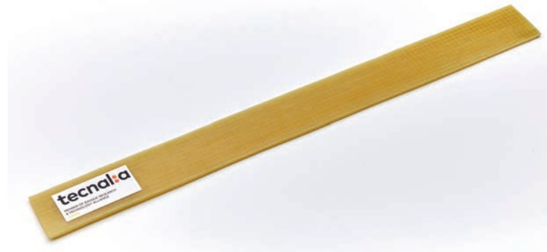
Figura 4. Demostrador de composite BIO-PUR/FV fabricado por RTM.
